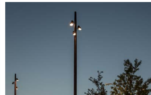
Figur 86. Strålkastare, BEGA - "77 651" och "77 652" på stolpe från Norpole - "XL". Bildkälla: Hans Logren
