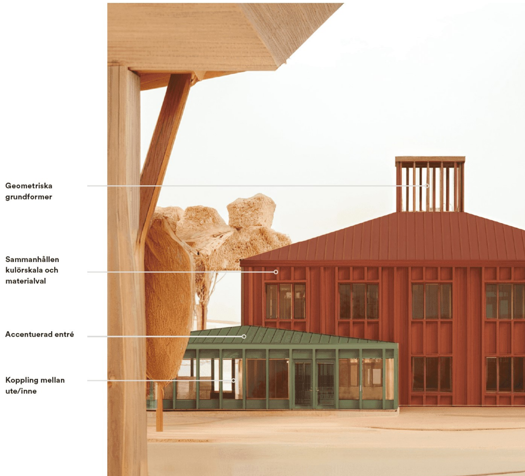
Figur 9: Illustration över föreslaget koncept för hur entréerna vid de nya tillbyggnaderna markeras med en annan kulör samt en egen entrévolym. Bild: FOJAB
