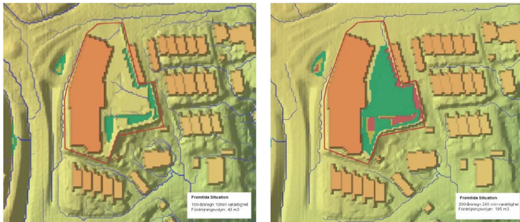
Figur 33 - Bild till vänster: Höjdmodell visar hur ett 10 minuter långt 100-årsregn hanteras genom att växtbäddar samt valda planterings- och gårdsytor tillåts översvämmas.
