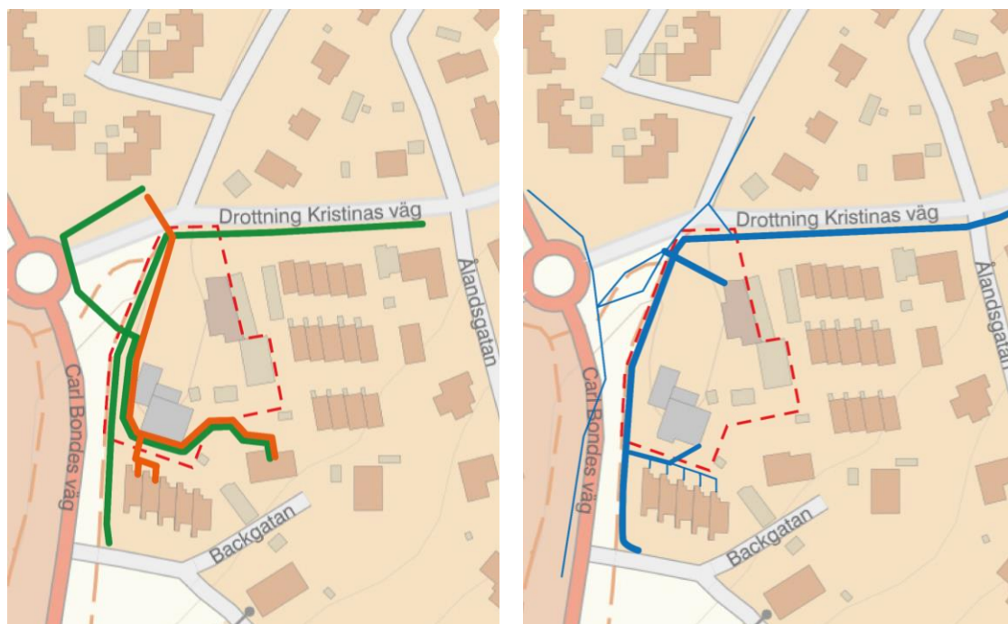
Figur 17 - Befintliga ledningsdragningar enligt Ledningskollen, visar ungefärliga dragningar. Orangea linjer visar fjärrvärme, gröna linjer visar fiber, blå linjer visar tele. Röd streckad linje visar planområde.
