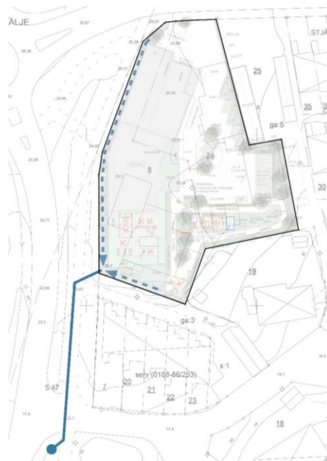
Figur 32 - Blå heldragen linje visar placering av ny ledning från fastighetens anslutningspunkt till utlopp i det öppna diket som rinner söder ut. Placeringarna är ungefärliga.
