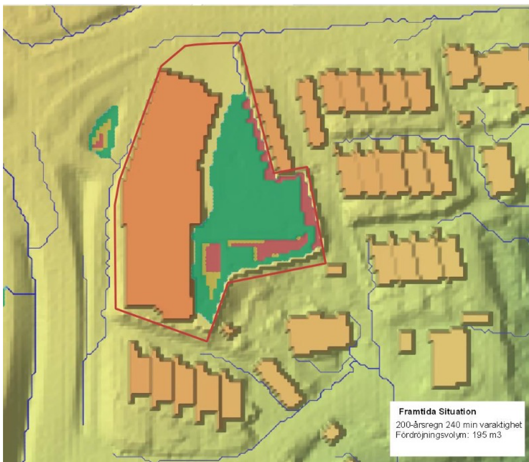
Figur 18 vid ytterligare kraftigare nederbörd (än 100-årsregn) breder översvämningen ut sig över parkerings- och trafikytorna för att slutligen bräddas ut till Drottning Kristinas väg. Höjdsättning i plangräns mot grannfastigheter säkerställer att dessa inte heller nu belastas.
