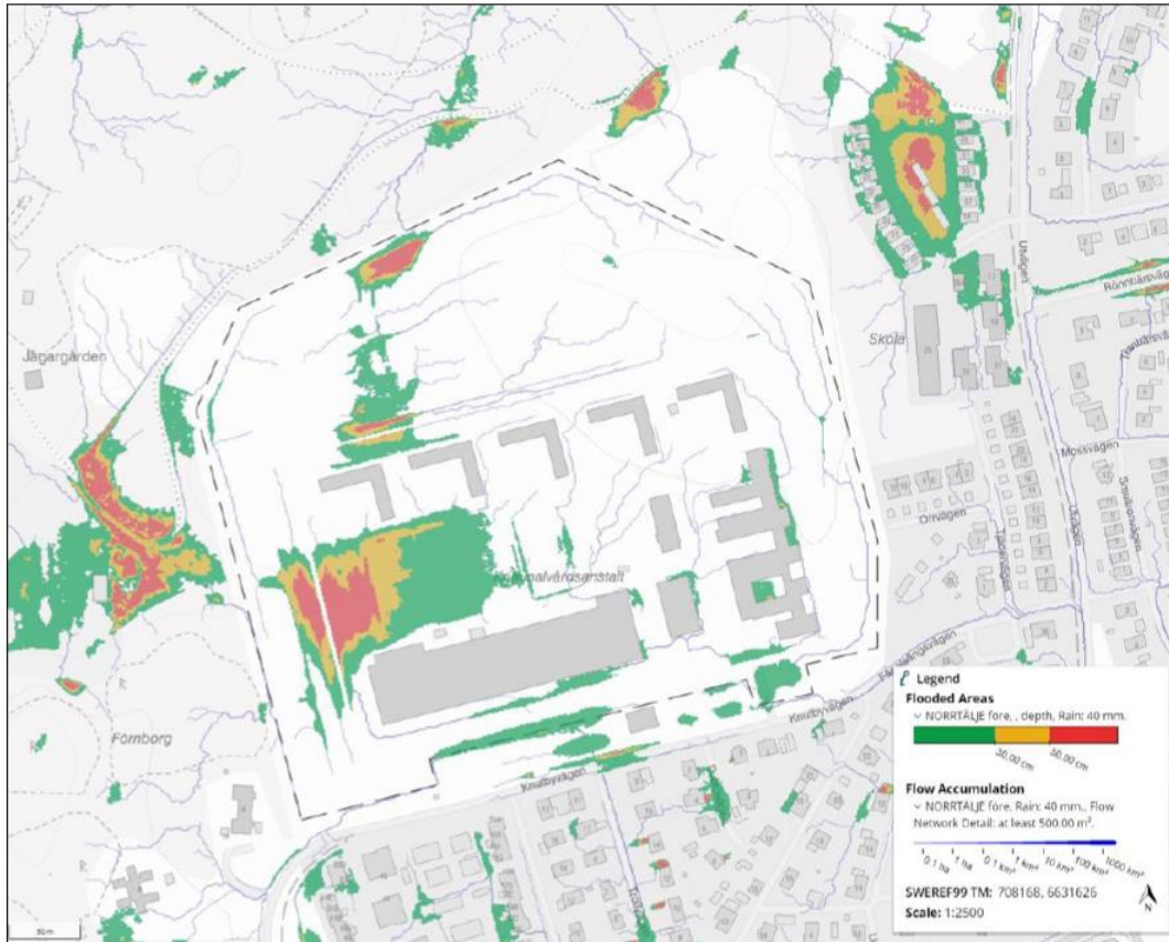
Utbredning av vattendjup vid 100-årsregn med 30 minuters varaktighet (54 mm) (WSP 2024-03-14).
