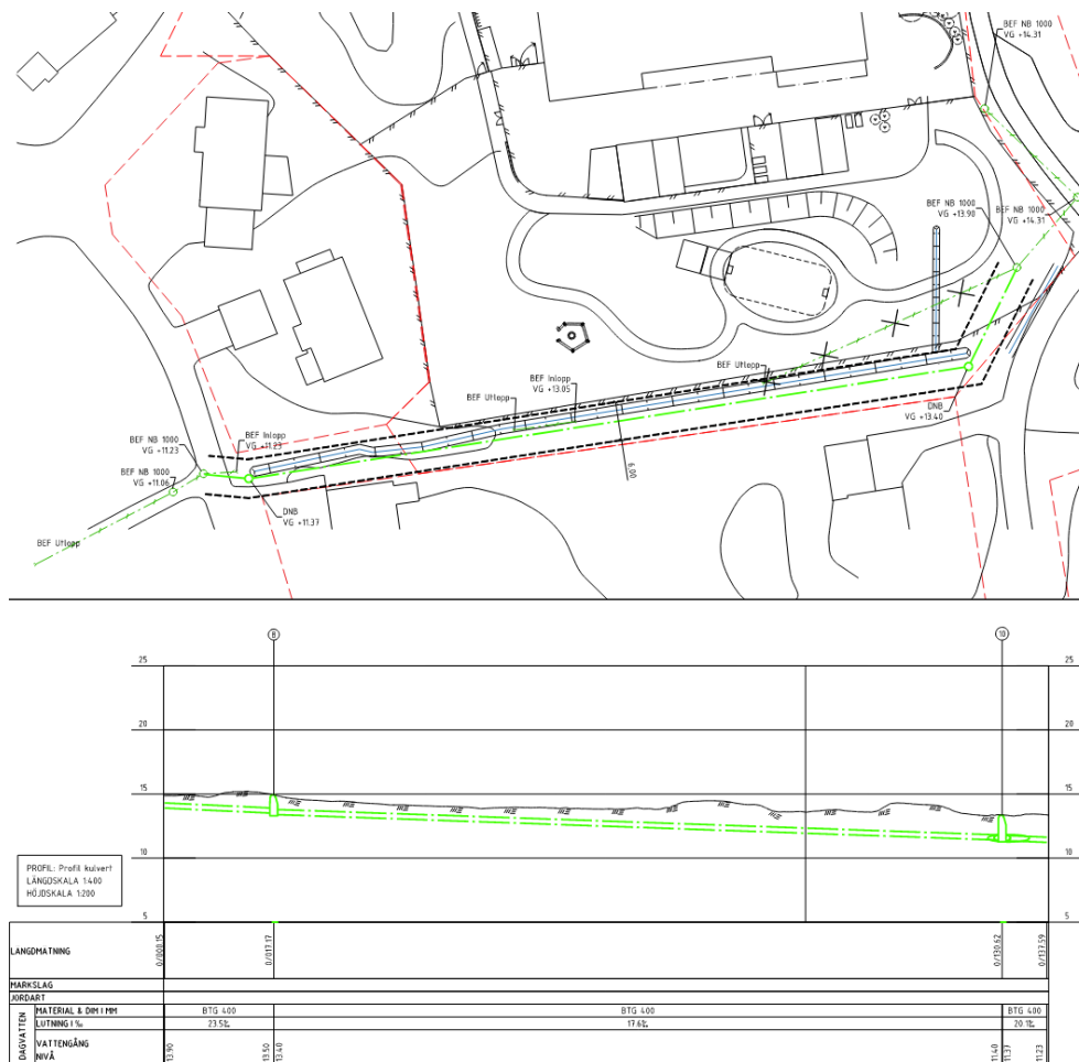
Figur 6-5. Förslag kulvertering, redovisas även i Bilaga 3.
