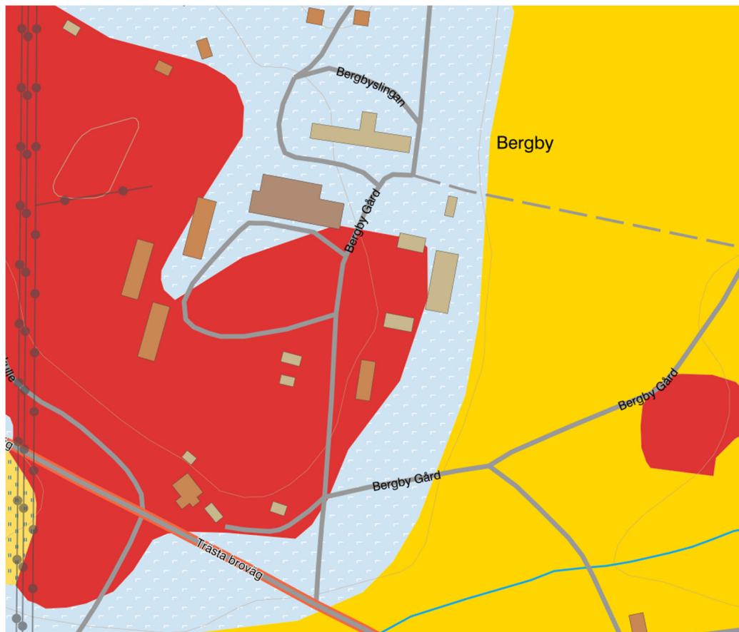
Figur 9. Röd färg betyder berg i dagen eller nära markytan. Ljusblått med hakar betyder lerig morän och glacial lera, karta: Sveriges Geologiska Undersökning SGU.
