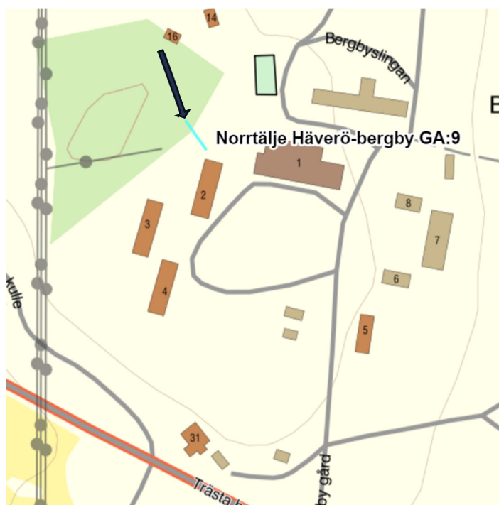
Figur 27. Gemensamhetsanläggning ga:9, turkos linje vid pilen, vatten- och avloppsledningar. Lantmäteriets webbkarta.
