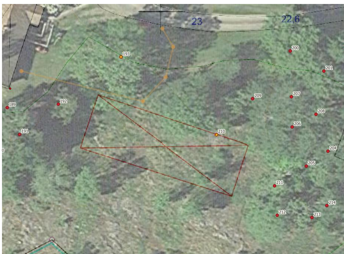
Figur 5: Gul linje visar ett exempel på placering av skyddsstaket runt träd 193 för att skydd vid byggnation.
