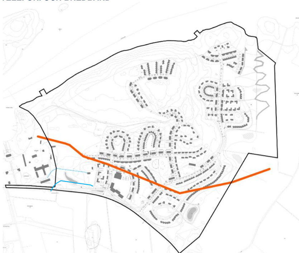
Figur 70. Ungefärligt läge befintliga ledningar. Blå ledning el och orange ledning tele/bredband. Illustration WSP.
