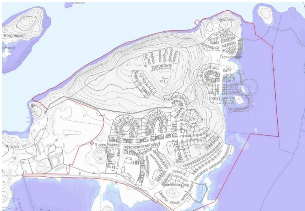
Figur 16. Blå-lila områden indikerar områden som i dagsläget ligger lägre än rekommenderad lägsta grundläggningsnivå +2,7 m. Planområdesgräns markerad med röd linje (bild från dagvattenutredningen, Bjerking, 2024).
