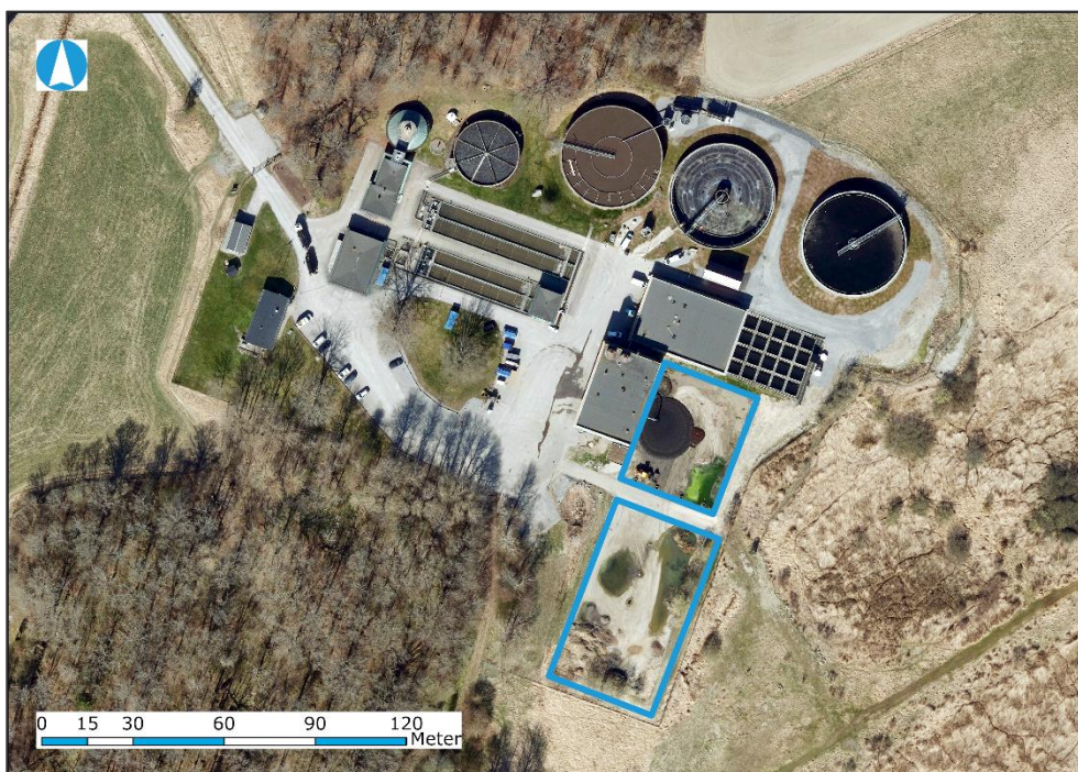
Figur 5. Flygfoto över verksamhetsområdet, de asfalterade ytorna där avloppsslammet mellanlagras är markerade med blått.
