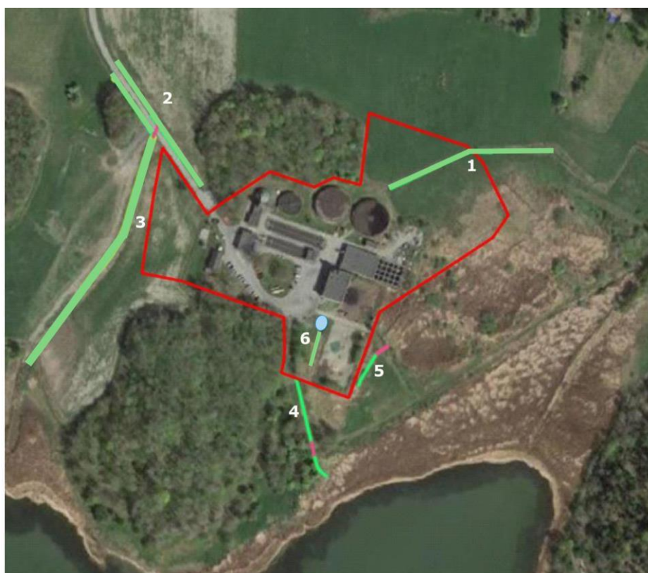
Figur 16: Befintliga diken 1–6 (grönmarkerad linje) och trummor (rosamarkerad linje) inom och i närhet till Lindholmens ARV. Område med dagvattendamm markeras med blå oval (Ramboll, 2023).
