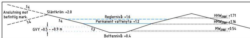
Figur 27: Normalsektion dagvattendamm. Ramboll, 2023).
