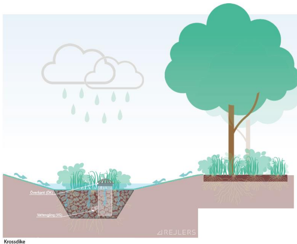
Figur 7-3. En principskiss på ett krossdike (Rejlers Sverige AB, 2023).
